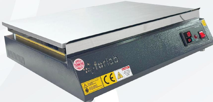
Isıtıcı Plakar Tekstil , tıp, gıda, kimya, ilaç vb. sektörlerin laboratuvarlarında 50 °C - 300 °C arası muhtelif ıslara ayarlanabilen cihazlardır. Isıtıcı rezistanslar alüminyum bloğun içerisinde gömülüdür bu sayede hızlı ve homojen bir ısı sağlanır. Plaka altında bulunan elyaflı reflektör sayesinde ısının alta geçişi önlenmiştir. Sürekli ısı gerektiren işlemler için 2 ayrı modelde üretilen tezgah üstü kullanılan cihazlardır.
